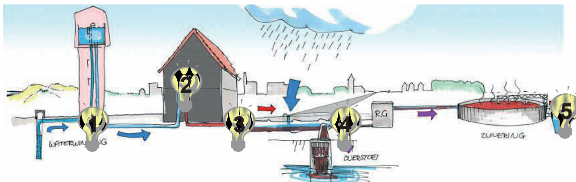
FIGUUR 5.3 LOCATIES VOOR (TERUG)WINNEN VAN THERMISCHE ENERGIE IN DE WATERKETEN
